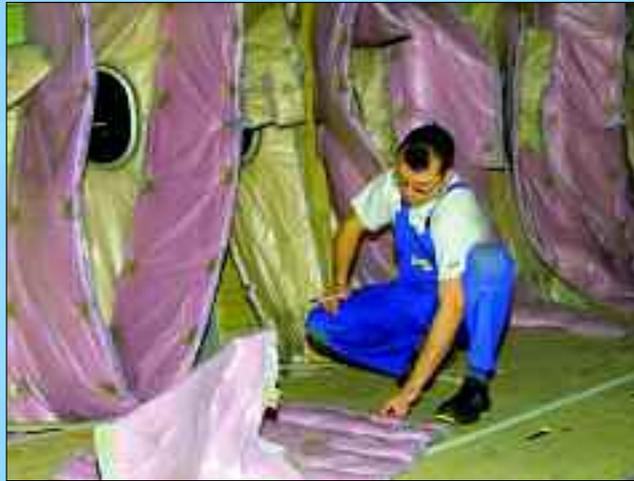
Hier ein Mitarbeiter der Olutex bei der Installation von Isoliermatten im Mitteldeck eines A 380
